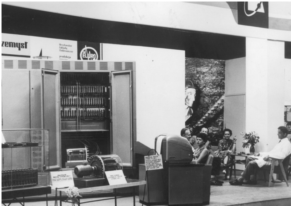
Maszyna UMC-1 na wystawie w Moskwie prezentuje się już znacznie lepiej. Zgodnie z zasadami ówczesnego PR na pierwszym planie wyeksponowano pamięć bębnową oraz naukowca w białym fartuchu, a w tle pracownię górnik.
